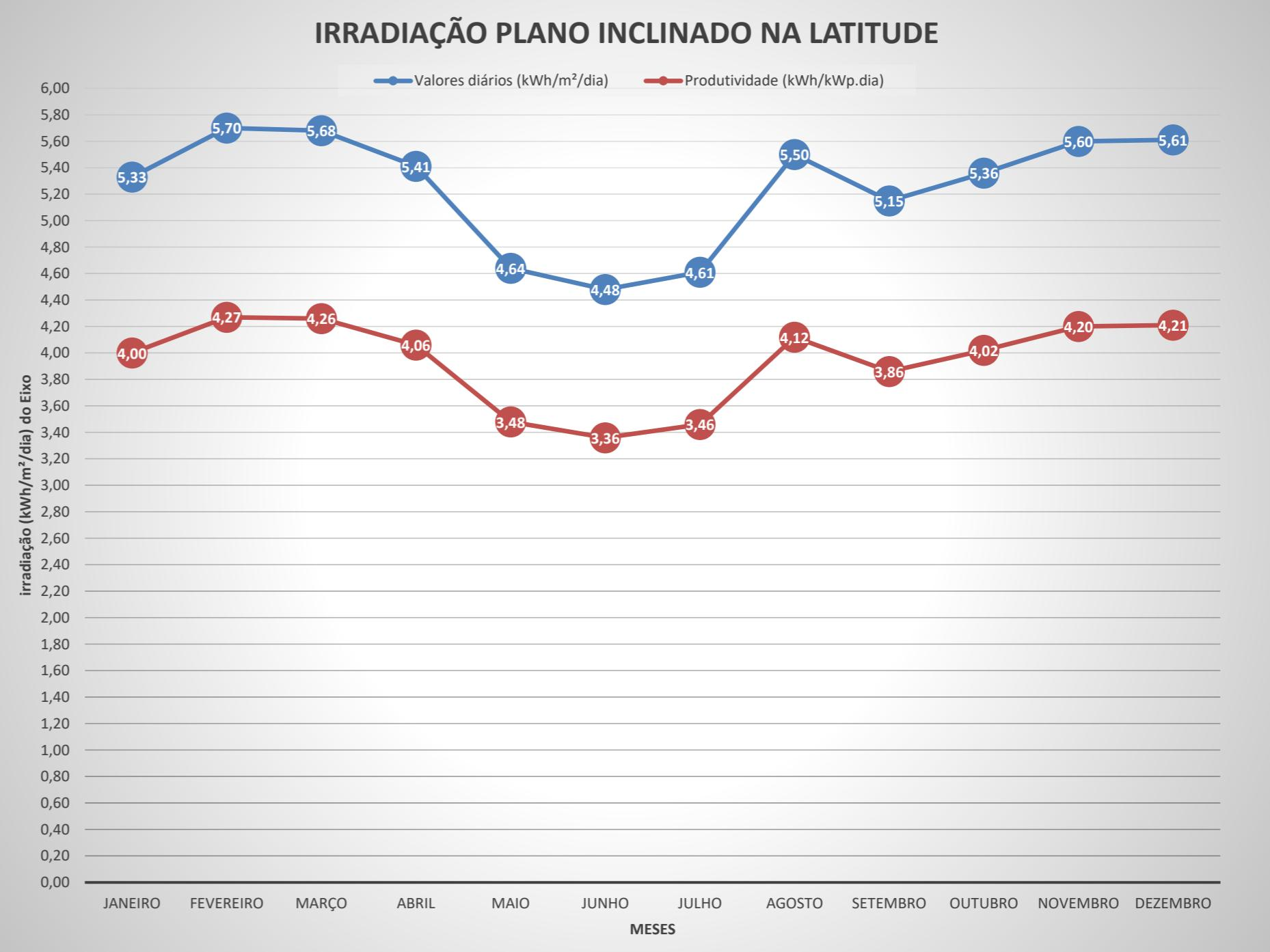
\*Produtividade (kWh/kWp.ano): Energia elétrica gerada por um sistema fotovoltaico de 1kWp e taxa de desempenho de 0,75.
